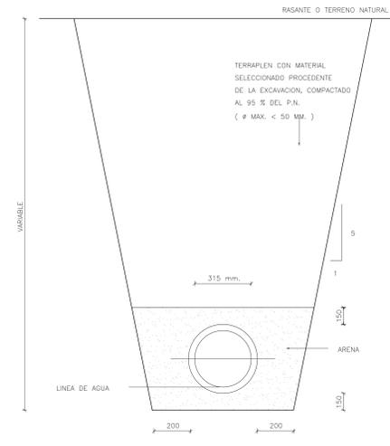
ZANJA TIPO ALCANTARILLADO
